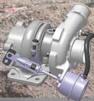
**Turbolader mit Ladedruck-Regelventil:** Ermöglicht es, die Abgase vom Turbinenrad wegzuleiten, damit der Ladedruck optimal geregelt werden kann und der Motor geschützt wird. Dies verringert auch die Zeitverzögerung, bevor der Turbolader das maximale Drehmoment erzeugt, und verringert den Verschleiß bei hohen Drehzahlen und geringer Belastung. Turbolader erhöhen die Luftdichte, so dass der Motor ungeachtet der Standorthöhe (ü. NN.) mehr Leistung erzeugt.
