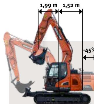
**Geringerer Heckschwenkradius:** Um den Einsatz in Innenstädten und auf engen Baustellen zu erleichtern, wurden der Heckschwenkradius um 24 % sowie der Frontschwenkradius um 45 % im Vergleich zum herkömmlichen DX140LC-5 verringert. Der geringste Schwenkdurchmesser beträgt nur 3,51 m.
